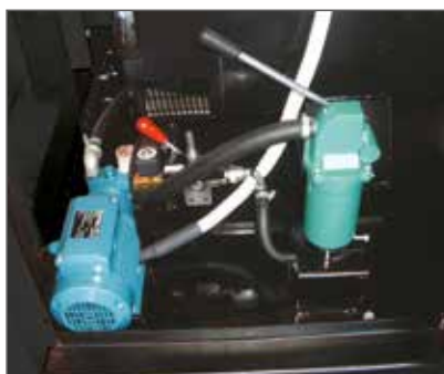
▲ Kit automático de llenado de combustible compuesto de: bomba eléctrica, bomba manual, tarjeta de control electrónico, transmisor de 4 niveles, válvula desviadora para bomba manual/eléctrica
