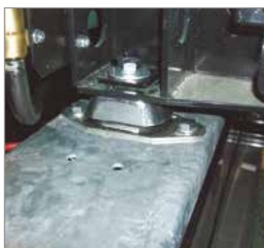
▲ Amortiguadores de vibración de alta calidad
