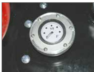
▲ Lector de nivel de combustible mecánico colocado junto al punto de llenado
