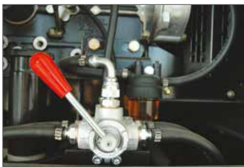
▲ Kit de válvula desviadora para el tanque de combustible externo
