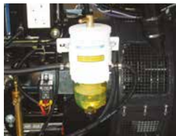
▲ Filtro separador de agua equivalente tipo Racor
