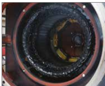
▲ Calentador anti-condensación para el alternador
